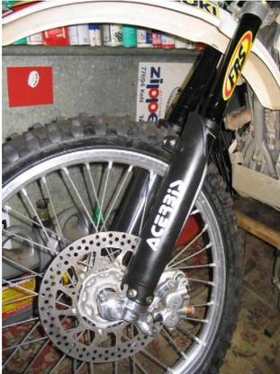
Abb. zeigt eine WP-Gabel inkl. Brembo-Bremsanlage & das Vorderrad einer KTM
